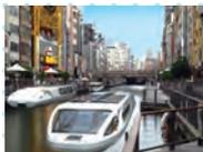
日本最先端技術を駆使したリチウムイオン電池推進旅客船(エコシップ)！旅客船としての事業化は「世界初」。開発コンセプトは静かで、排ガスゼロ、川を全く汚さない「水都大阪」にふさわしい近未来の観光船です。
